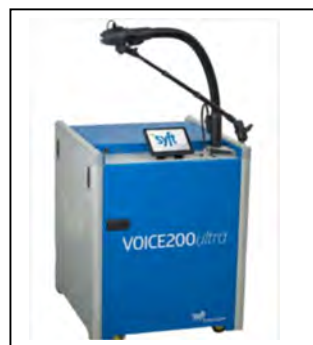
Figure 1 : Syft Technologies Voice 2000ultra SIFT-MS
